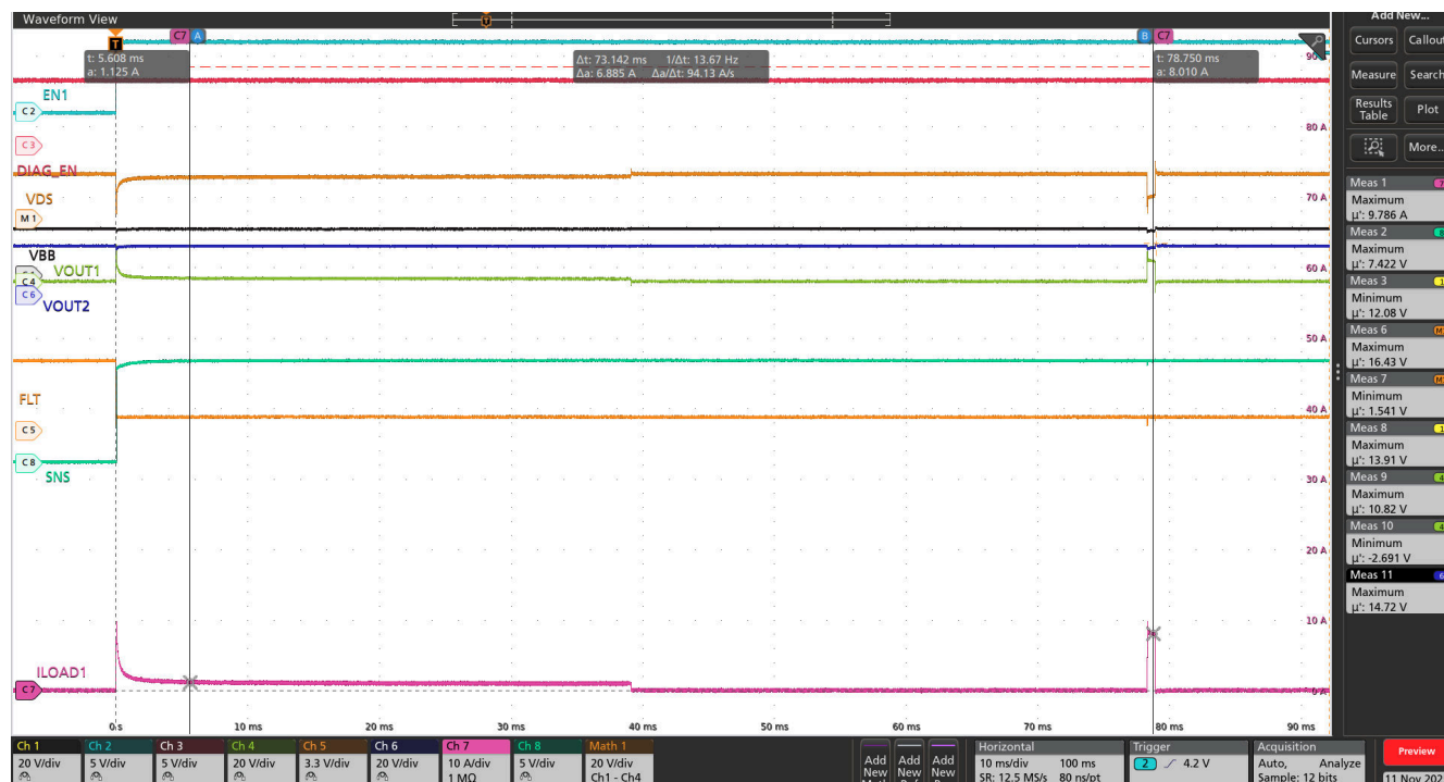
图 8-23. 器件进入延长重试窗口，在初始重试窗口中具有热调节行为
