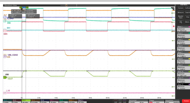
图 9-7. 通道 1 输出短接至 GND 时的器件导通行为
