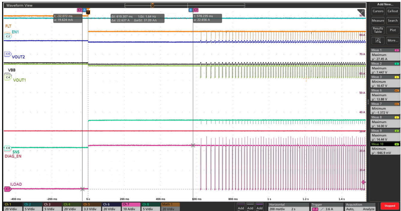
图 8-19. 对于负载电流 ( 22A 电子负载 ) 小于电流限制 ( ILIM = GND ) 的情况，器件进入无限热关断重试阶段
