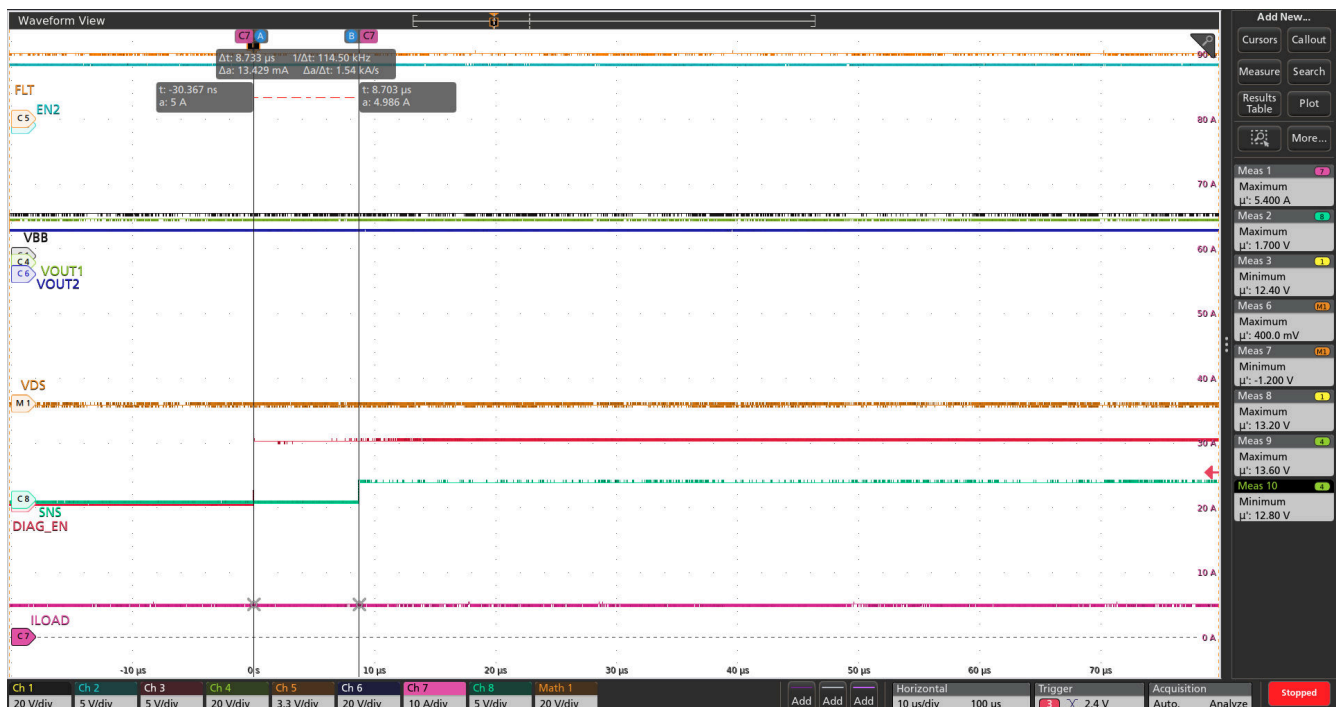
图 8-5. DIAG_EN 触发的 SNS 响应时间 ( t_{SNSION1} )
