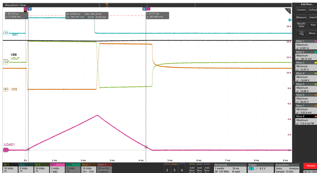
图 8-27. 5mH 电感负载驱动 (VBB = 13.5V、TA = 25°C)
