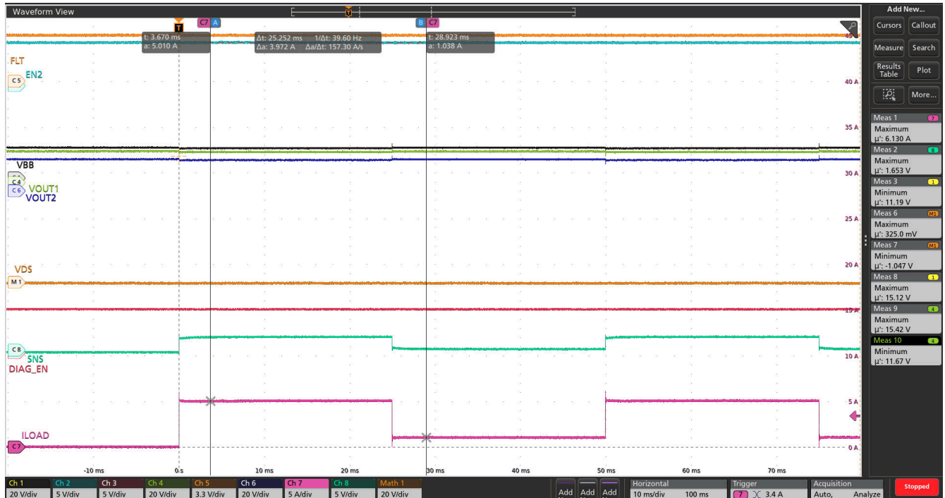
图 8-4. 通道 1 上负载电流变化时的 SNS 引脚电压 ( R_{SNS} = 1k\Omega , SEL = 0 )
