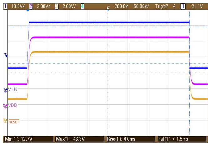
图 51. TPS3840-Q1 Cold-Start Test Pulse
