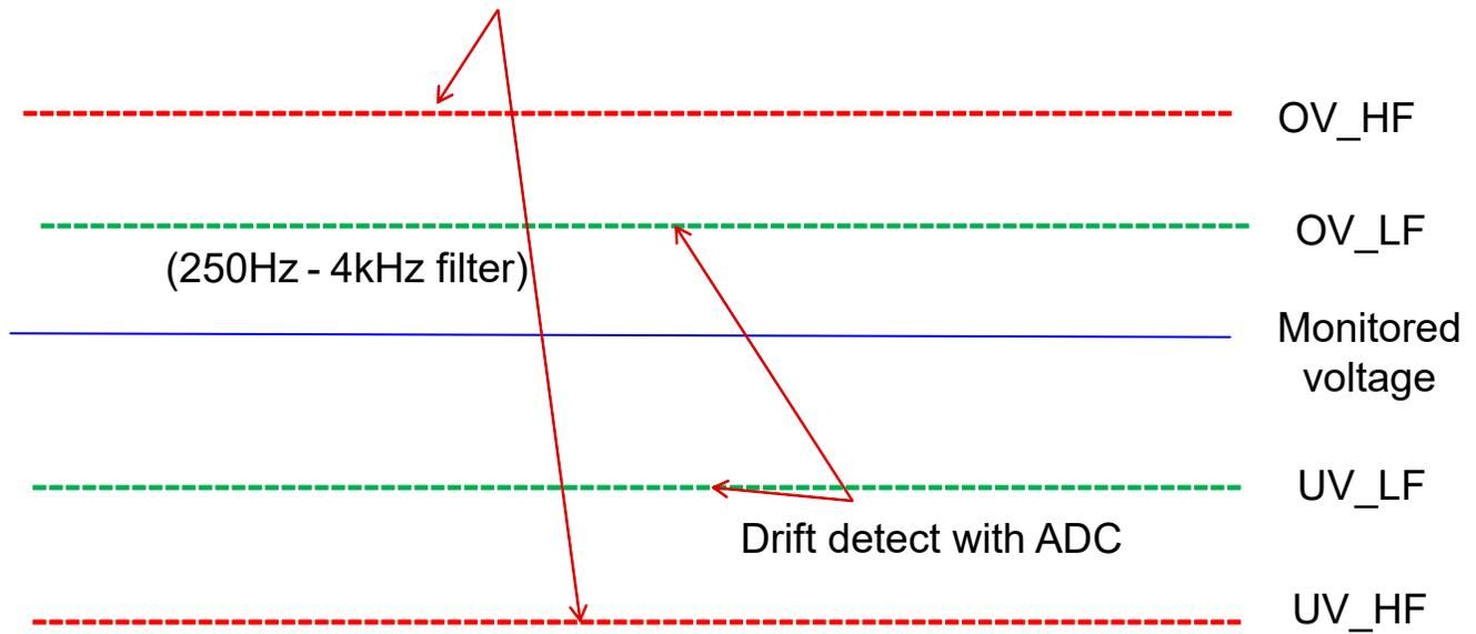
图 7-6. MON Channel State Diagram
