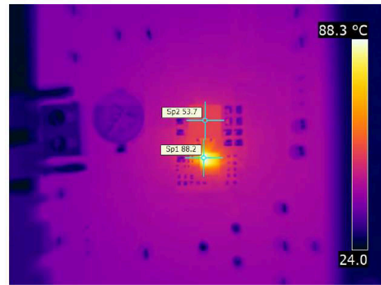
图 6-14. Thermal Image at 14-A Output Current
