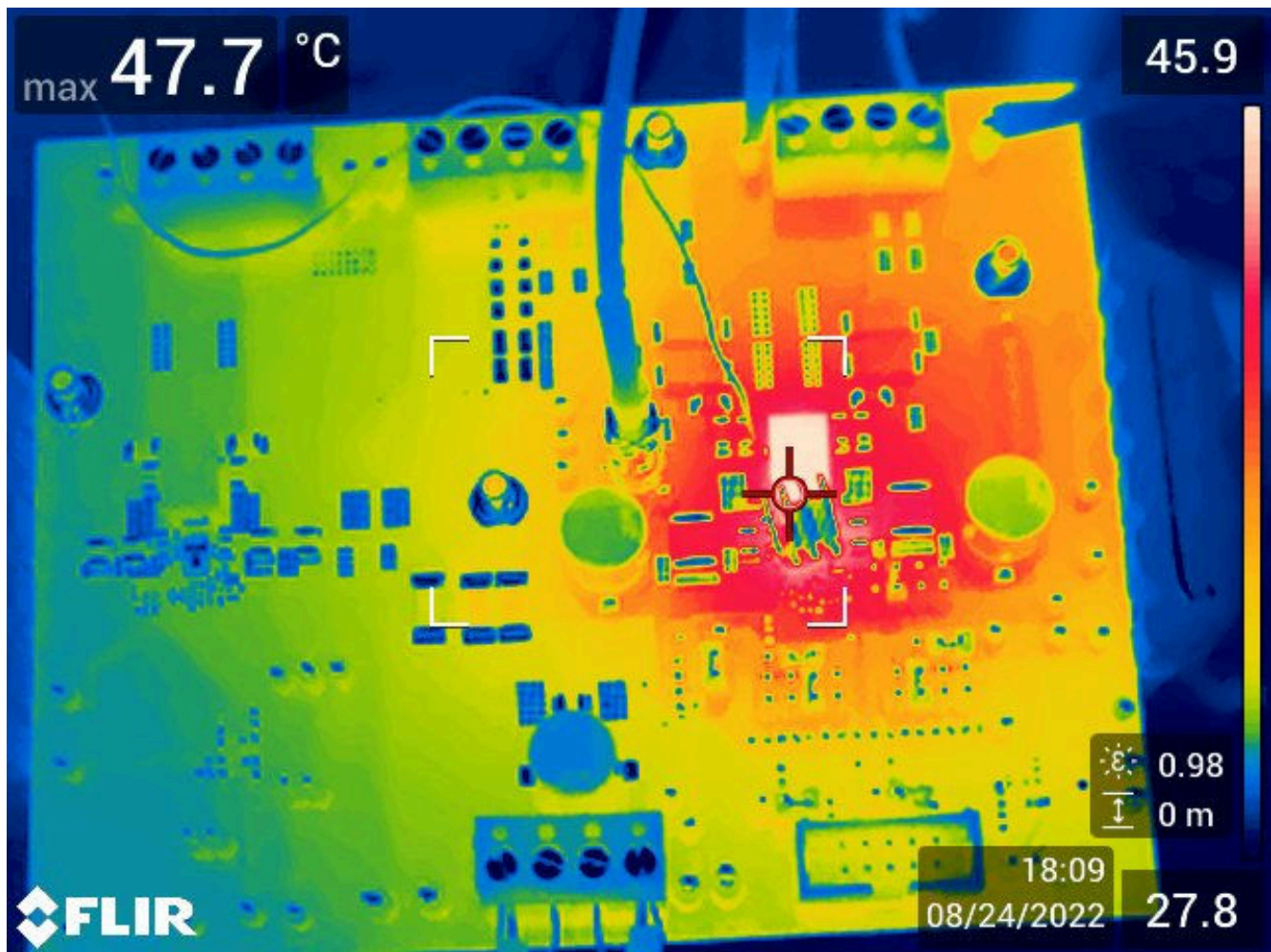
图 7-24. 25^\circ\text{C} 环境温度下的热图像
