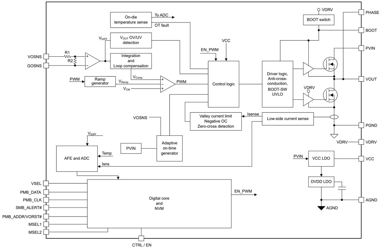
图 6-1. 选择内部反馈时的方框图
