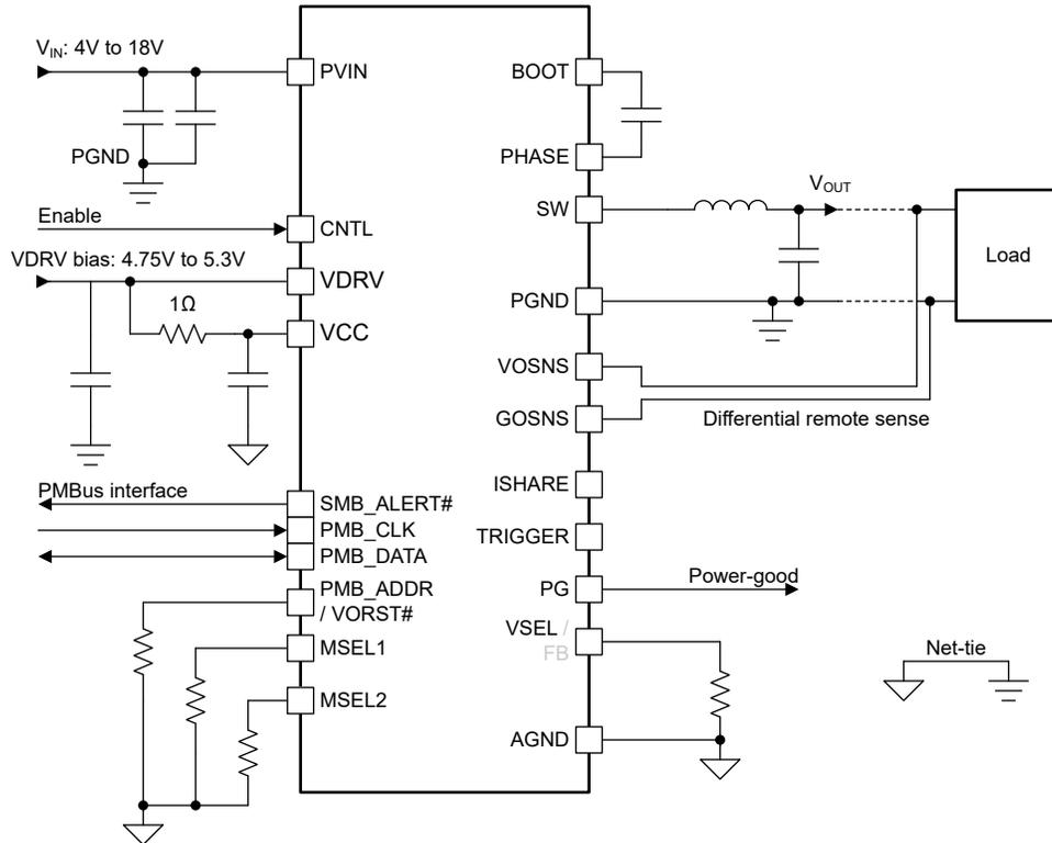
图 6-6. 具有外部 VCC 偏置的双电源配置
