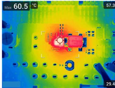
图 8-9. 热特性，800kHz FCCM，内部 LDO，25A 负载
