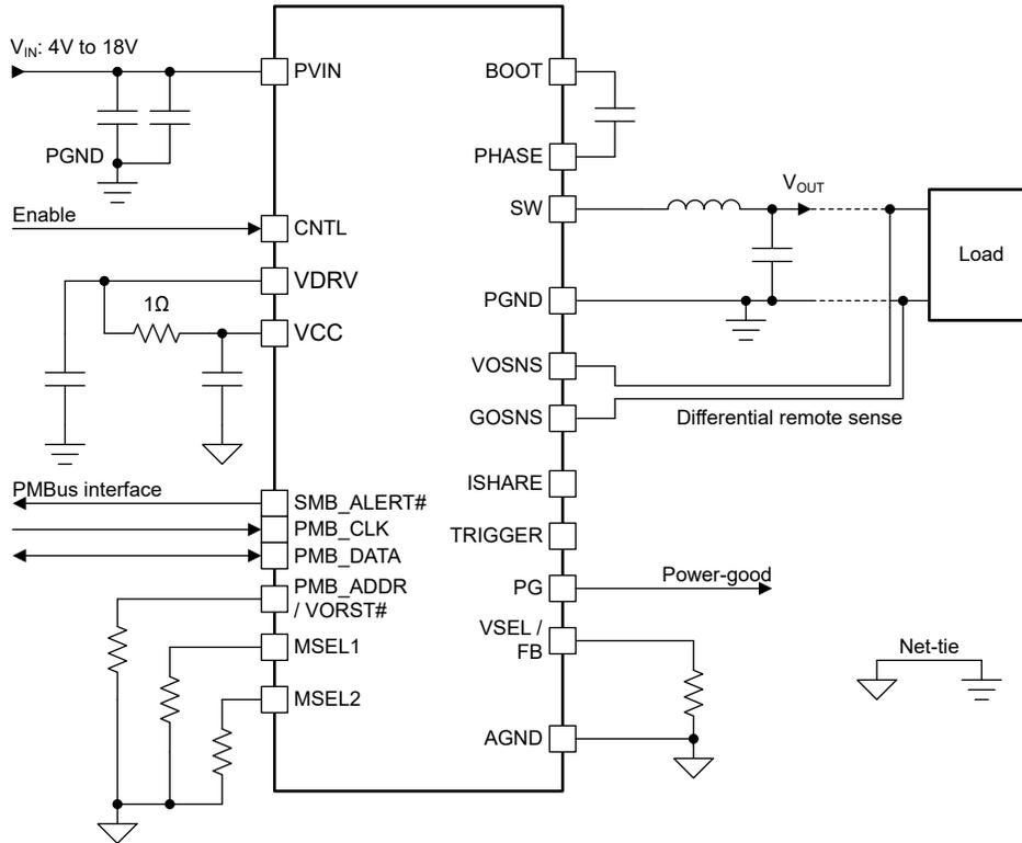
图 6-5. 具有 12V 总线的单  $V_{IN}$  配置
