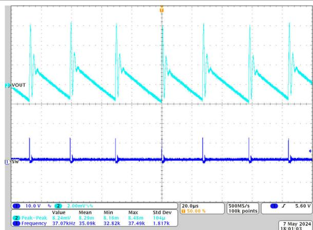
图 8-7. 输出电压纹波，1.2V Vout，800kHz DCM，空载
