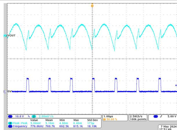
图 8-6. 输出电压纹波，1.2V Vout，800kHz FCCM，25A 负载
