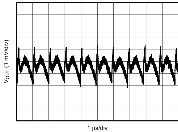
图 5-1. 第 1 个 L-C 滤波器之后的 V_{OUT} 纹波
