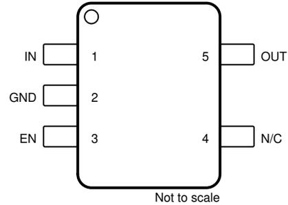
图 4-4. DBV Package, 5-Pin SOT-23 (Top View)
