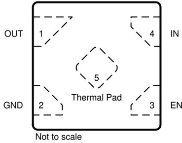
图 4-3. DQN Package, 4-Pin X2SON (Top View)
