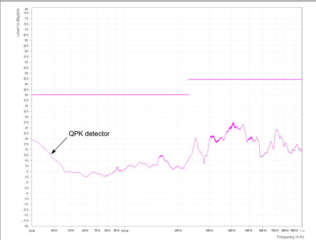
图 9-9. 符合 CISPR 32 B 类辐射发射限制：垂直极化
