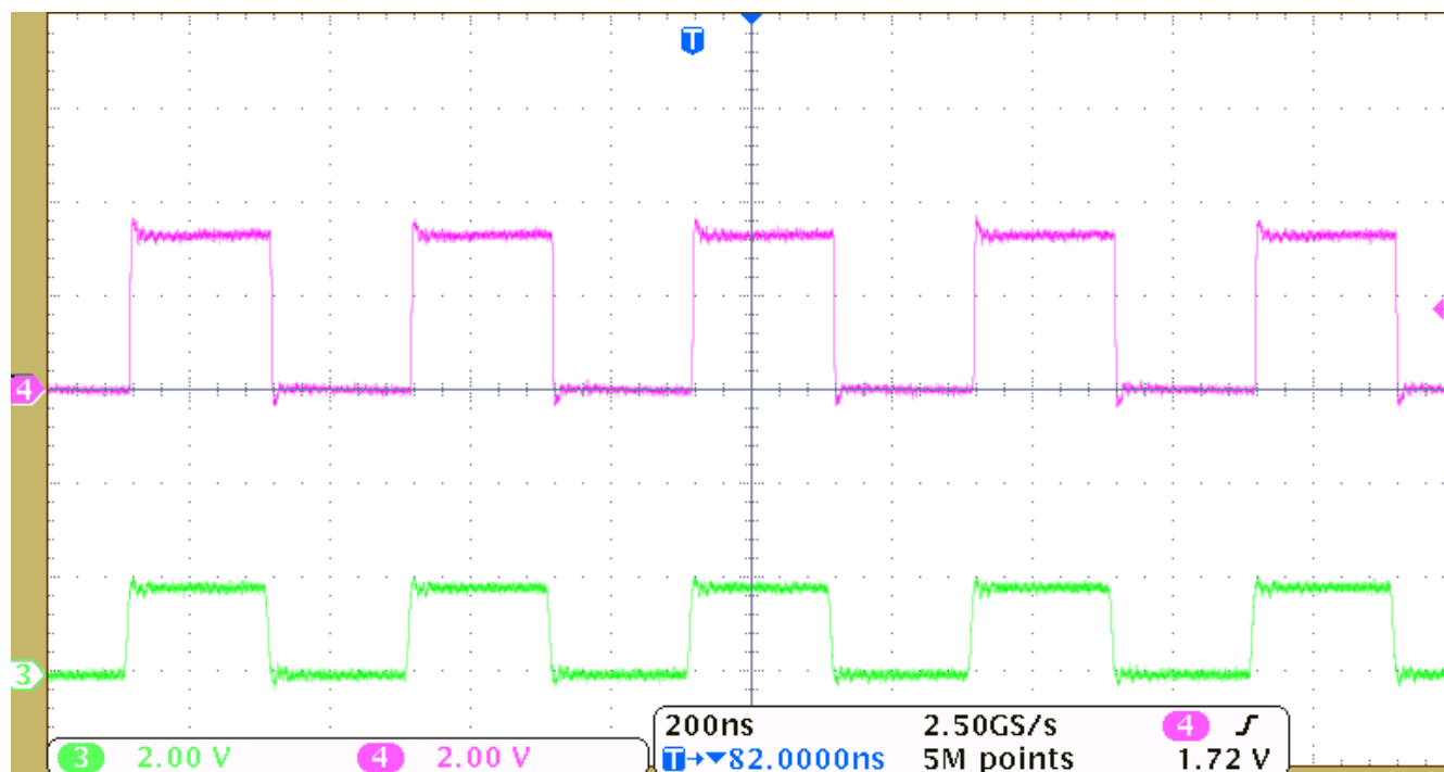
图 8-2. 2.5MHz 1.8V 信号 ( 绿色 ) 到 3.3V 信号 ( 粉色 ) 的电平转换示例
