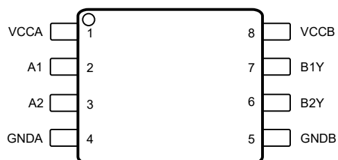
图 4-4. TXGx020DDF 8 引脚 SOT 和 TXGx020D 8 引脚 SOIC (顶视图)
