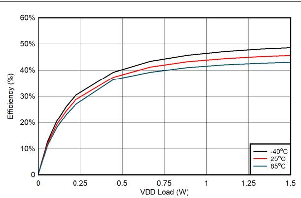
图 6-21.  $V_{VDD-VEE}$  上效率与负载间的关系:  $V_{IN} = 18V$ ,  $V_{VDD-VEE} = 22V$ ,  $V_{COM-VEE} = 4V$ ,  $V_{COM-VEE}$  无负载
