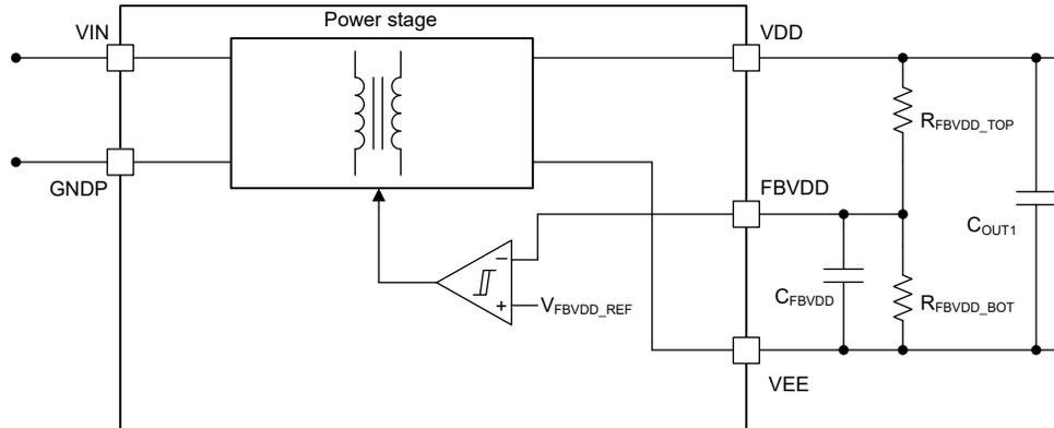
图 7-1. VDD-VEE 电压调节
