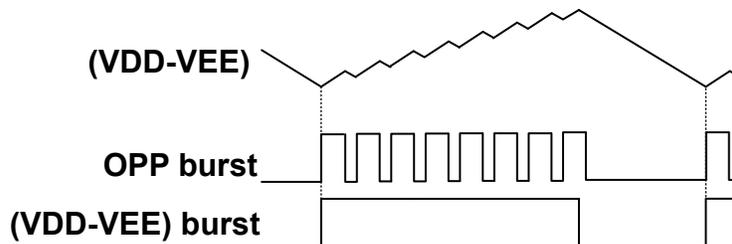
图 7-4. 带小型突发的过功率保护示意图
