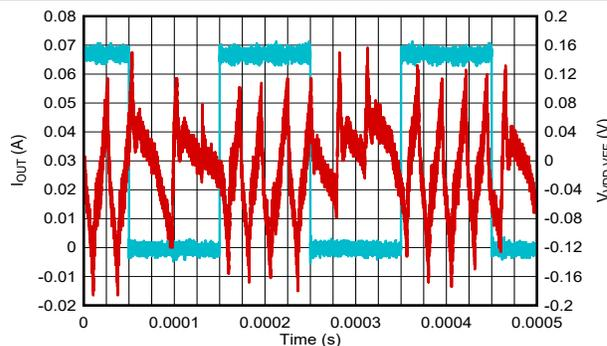
图 6-9. 负载瞬态响应: 在空载和 1.5W 之间,  $V_{IN} = 15V$ ,  $V_{VDD-VEE} = 22V$ ,  $V_{COM-VEE} = 4V$
