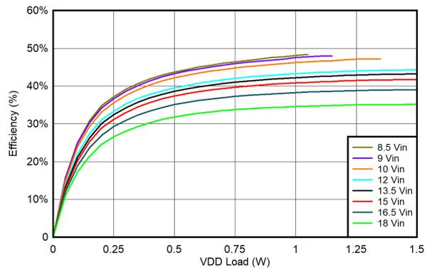
图 6-31. UCC14341B-Q1  $V_{VDD-VEE}$  上效率与负载间的关系 :  $T_{AMBIENT} = 25^{\circ}C$  ,  $V_{VDD-VEE} = 15V$  ,  $V_{COM-VEE} = 4V$  ,  $V_{COM-VEE}$  无负载
