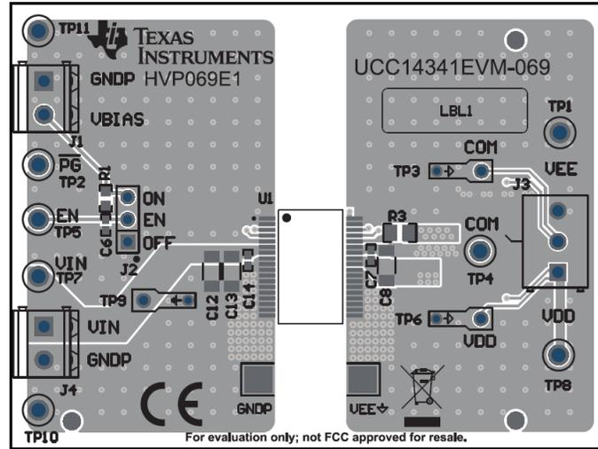
图 8-21. UCC14341-Q1EVM , PCB 顶层, 组装
