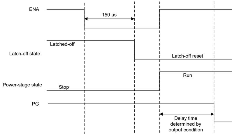
图 7-6. 使用 ENA 引脚的闭锁复位
