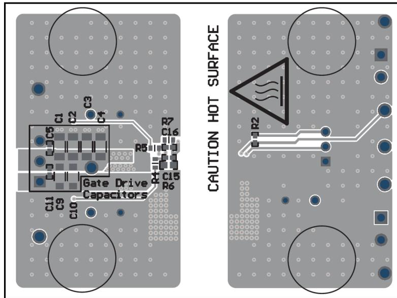
图 8-24. UCC14341-Q1EVM , PCB 底层 , 组装 ( 镜像视图 )
