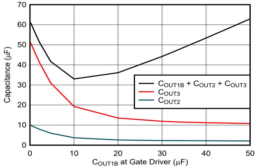
图 8-5. 输出电容随  $C_{out1B}$  选择的变化
