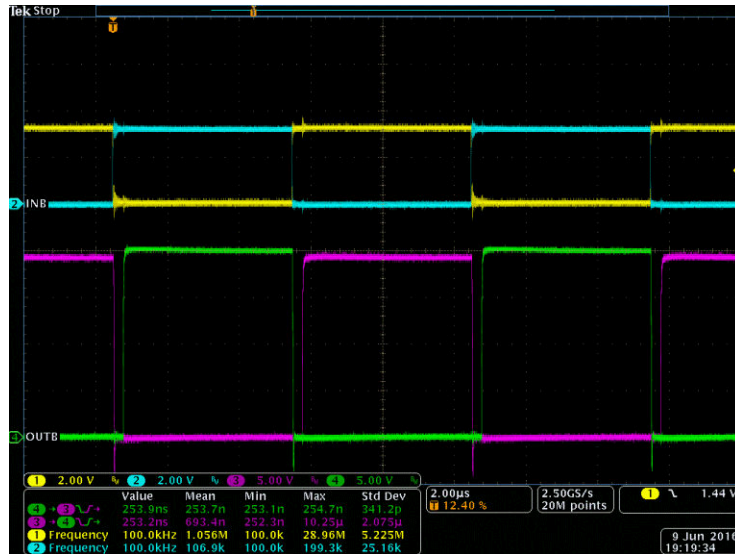
图 8-5. INA/B 和 OUTA/B 的台架测试波形
