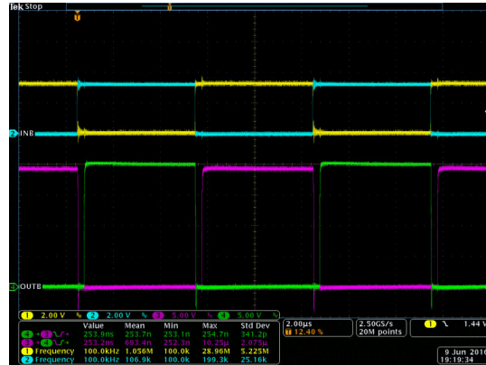
图 8-5. INA/B 和 OUTA/B 的台架测试波形
