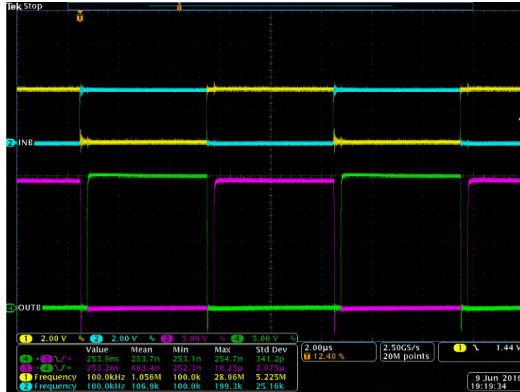
图 8-5. INA/B 和 OUTA/B 的台架测试波形
