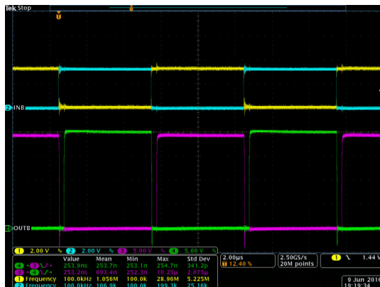
图 8-5. INA/B 和 OUTA/B 的台架测试波形
