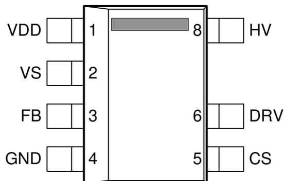
图 5-1. D Package 7-Pin SOIC Top View
