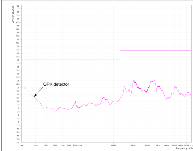
图 5-29. 符合 CISPR 32 B 类辐射发射限制：水平极性
