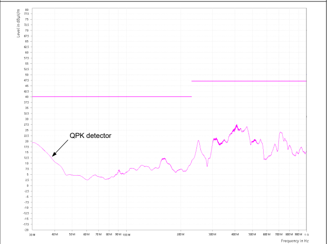
图 5-30. 符合 CISPR 32 B 类辐射发射限制：垂直极性
