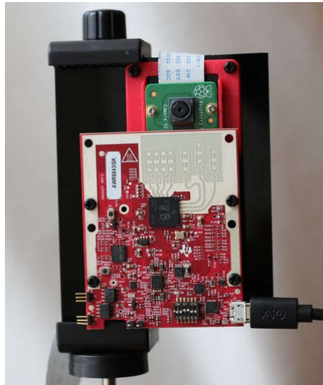
그림 3. IMX219 및 IWR6843ISK를 기반으로 제작된 카메라 및 레이더 센서 모듈
