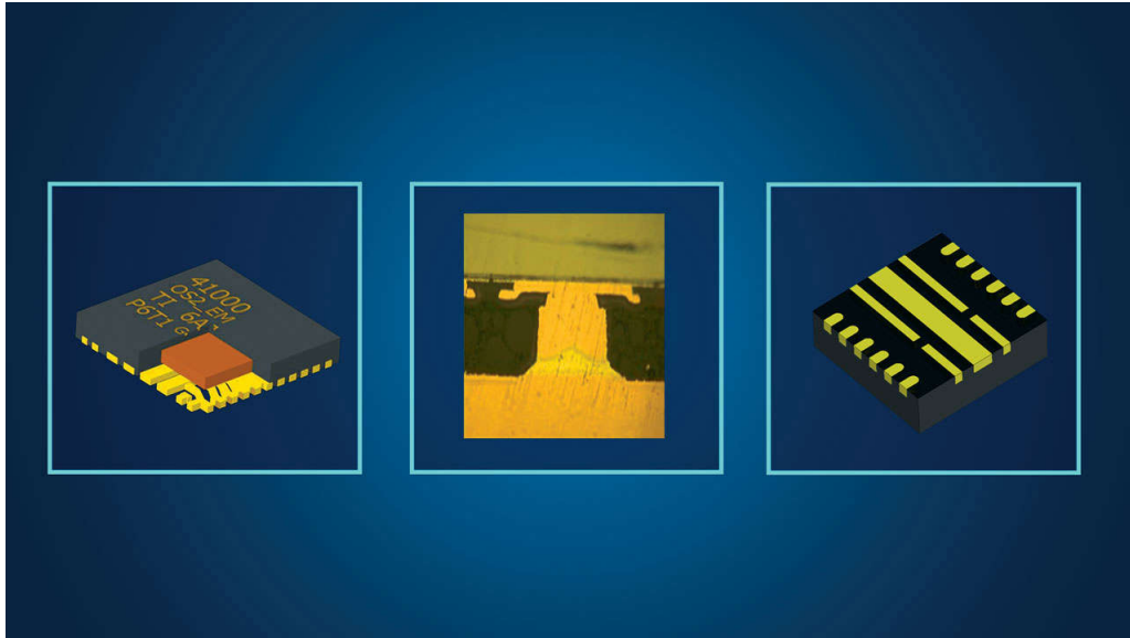
그림 7. 구리 범프는 실리콘 다이를 패키지의 구리에 직결하여 FET에서 PCB까지 거의 직접적인 경로를 제공합니다.
