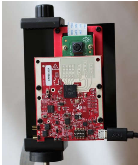
圖 3. 以 IMX219 和 IWR6843ISK 打造的攝影機與雷達感測器模組
