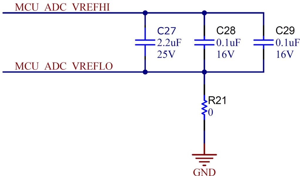
**Figure 2-4. LP-AM13E230 VREF Decoupling**
