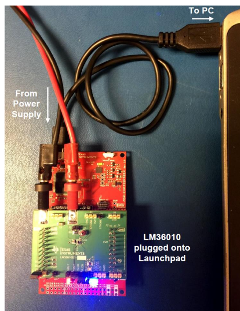
Figure 6. LM36010EVM Test Setup
