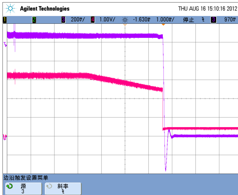
图 2：输出电压在关机时的负过冲
