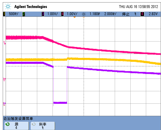
图 12: SRE_1B, 3.3V 和 1.8V 的波形
