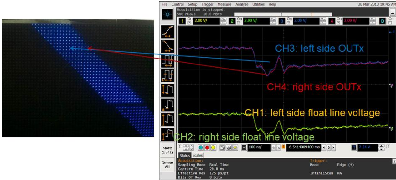
图 11 行线多次放电方案测试结果
