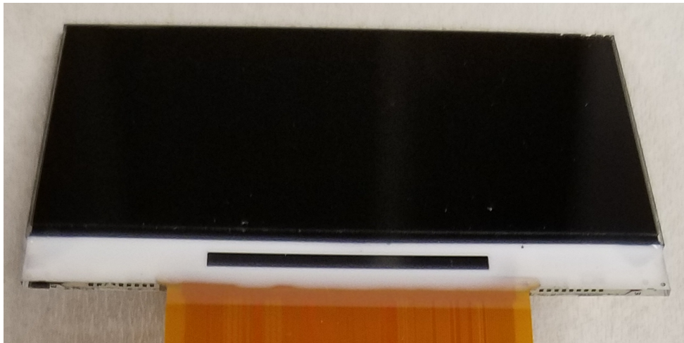
图 12. 用于日光测试的 TFT 面板。部件号 E06030K16。
