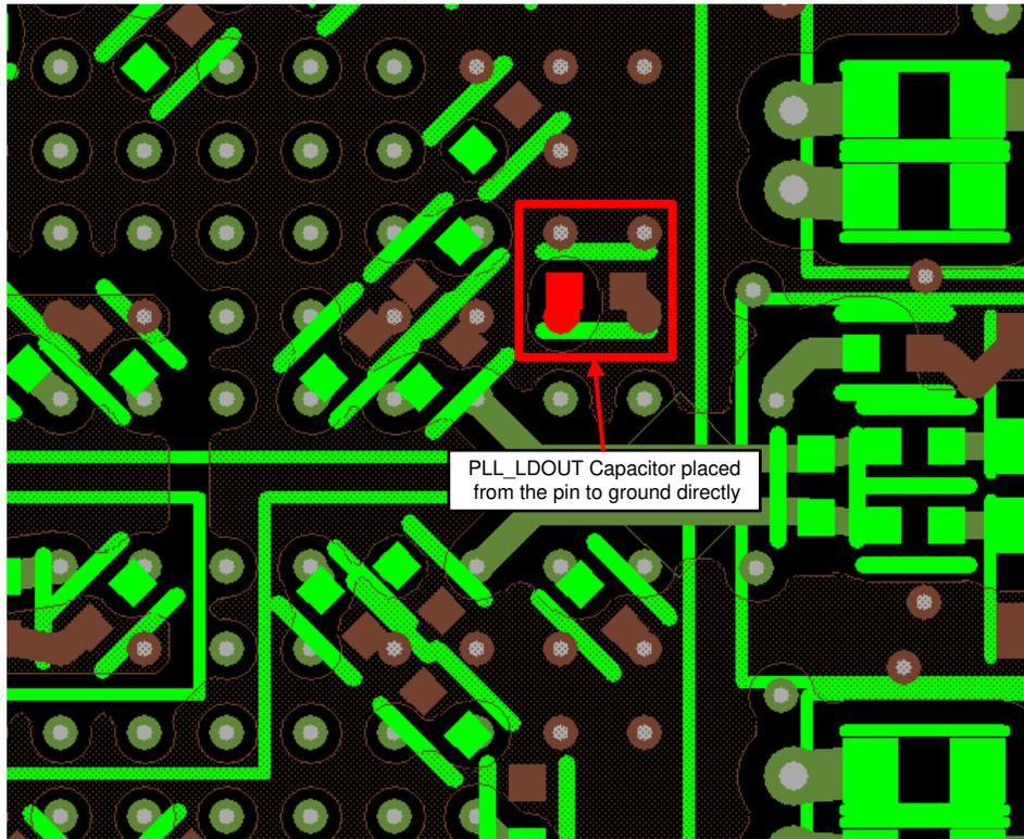
图 6-8. PLL\_LDOUT 0.1 $\mu$ F 电容器从引脚 J19 (PLL\_LDOUT) 路由到引脚 J18 (VSSPLLCLKREF)
