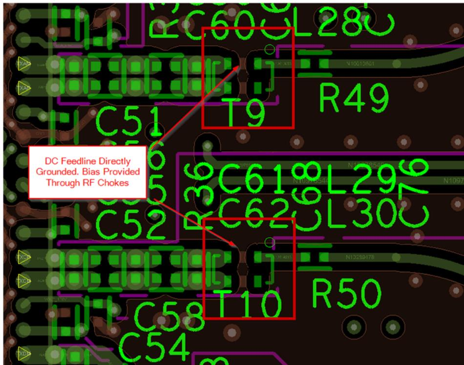
图 8-4. 当前实施的方案：直流馈线直接接地。通过射频扼流圈提供偏置
