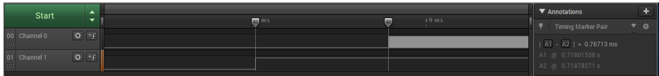
图 3-2. 提供快速锁定代码示例的 MSP430FR2355 LaunchPad™ 开发套件的 FLL 锁定时间
