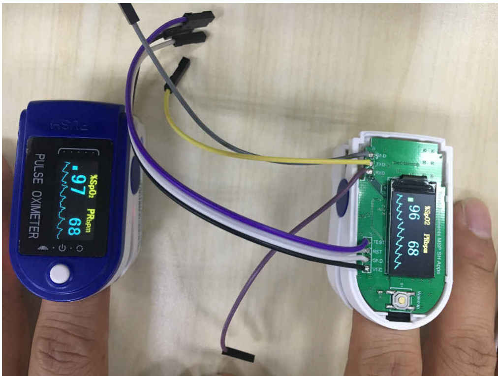
图 7-2. 比较测试 (左: MP 脉搏血氧计, 右: 基于 FR2355 的演示版)
