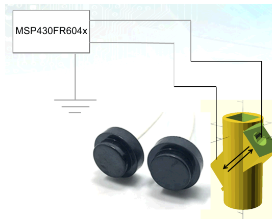
图 2-2. Jiakang 2MHz 超声波配置
