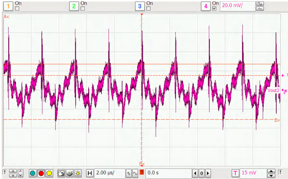
图 4-4. 满载条件下的次级输出电压纹波
