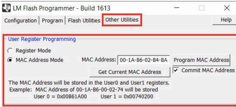
图 6-2. 使用 LM Flash Programmer 进行 MAC 地址编程
