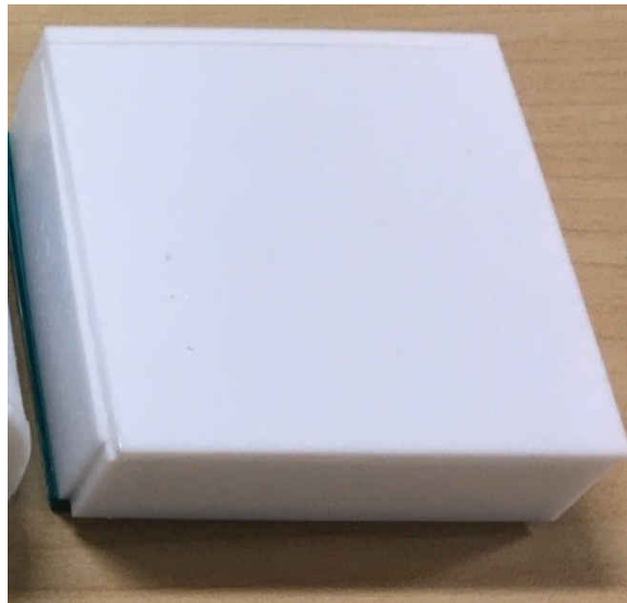
图 6-4. 壁厚为 1.524mm 的 PTFE 板材矩形雷达天线罩
