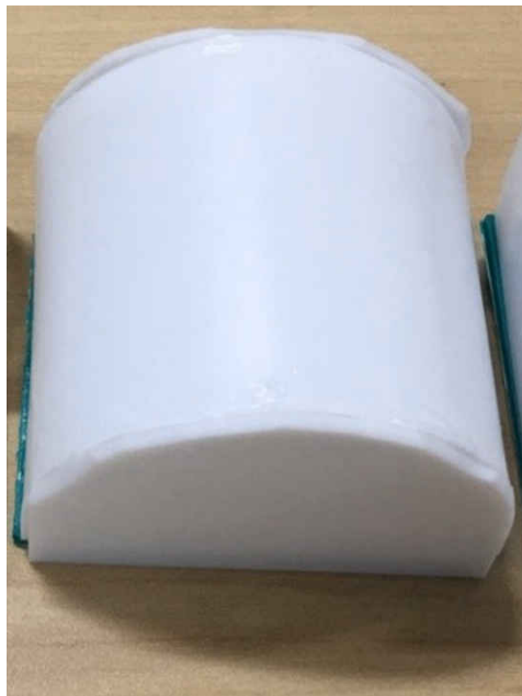
图 6-7. 壁厚为 1.524mm 的 PTFE 弧形雷达天线罩
