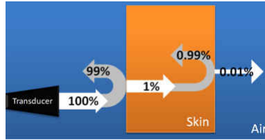
图 3-2. 皮肤和空气界面的反射系数
