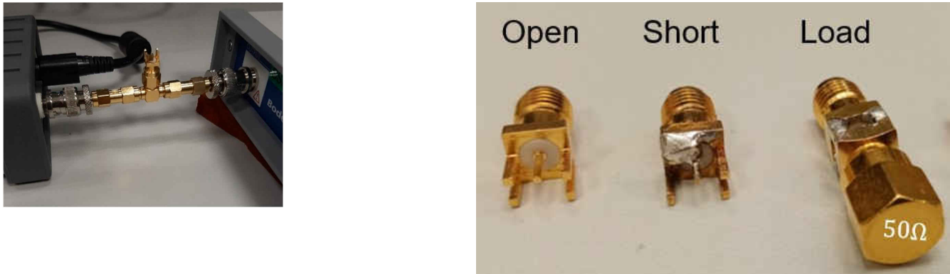
图 3-1. 带有 T 形连接器 (左) 和校准元件 (右) 的系统设置
