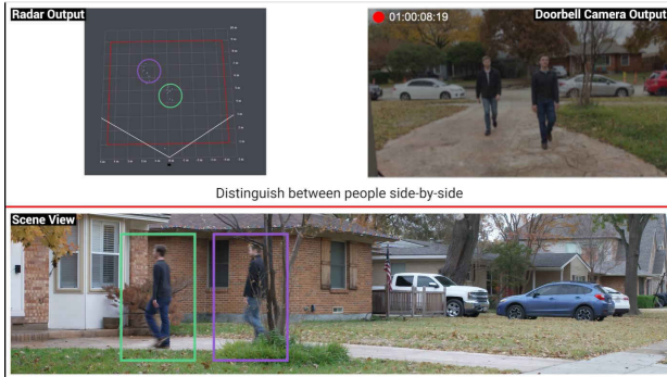
图 2. 显示了摄像头和雷达输出的 IWRL6432 可视门铃演示
