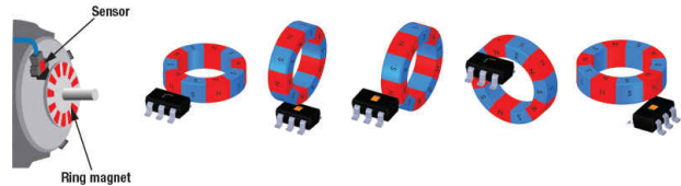
图 4. 采用环形磁体和各种传感器布局实现的旋转编码
