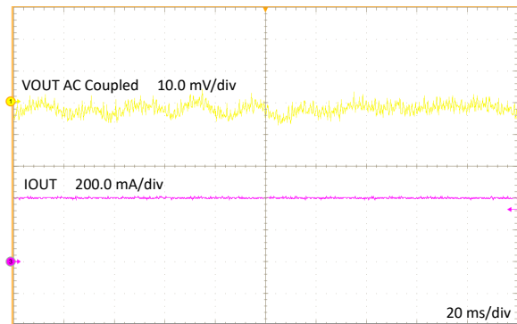
图 4-10. V_{IN} = 24V 、 V_{OUT} = -12V 、 I_{OUT} = 410mA 时的输出电压波纹
