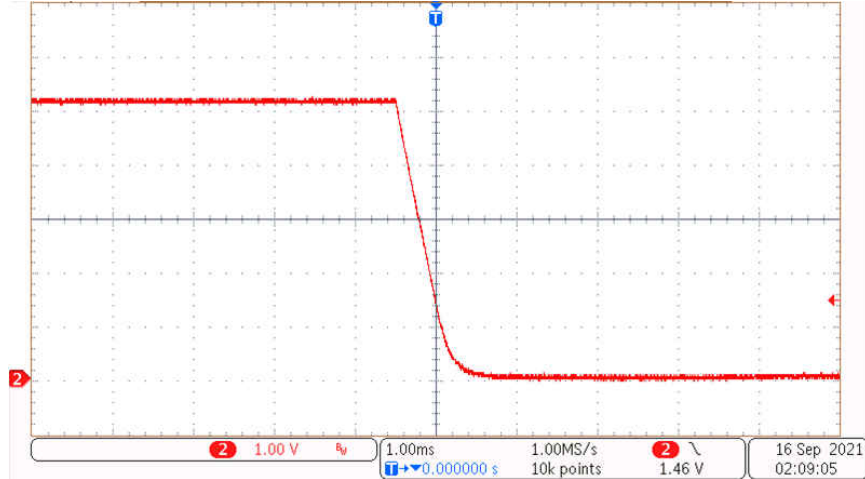
图 2-10. 输出满载时的关断
