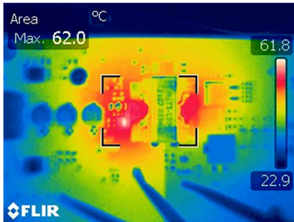
图 2-3. 28V 输入电压的顶部电路板热特性
