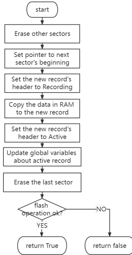
图 3-8. EEPROM_TypeA_repairFormat 的软件流程
