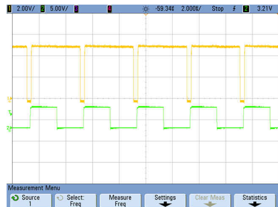
图 6-3. 满载且 50% 占空比时钟时进行同步
