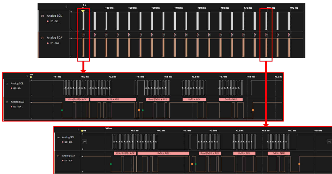
图 4-7. 所捕获的用于读取电池电压的 I2C 波形
