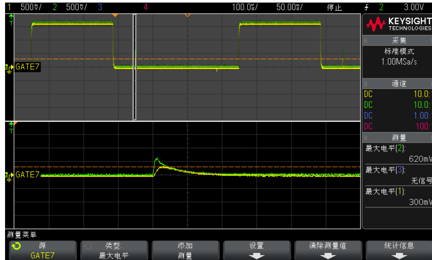
图 15: Test 4 的 MOSFET 的 Vgs 的波形
