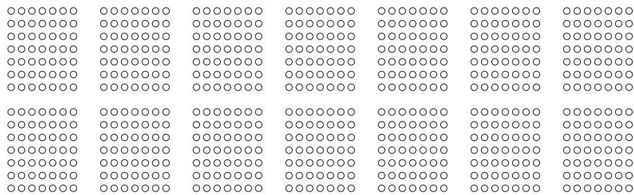
图 1-37. 中央磁芯周围的利兹线绕组模型
