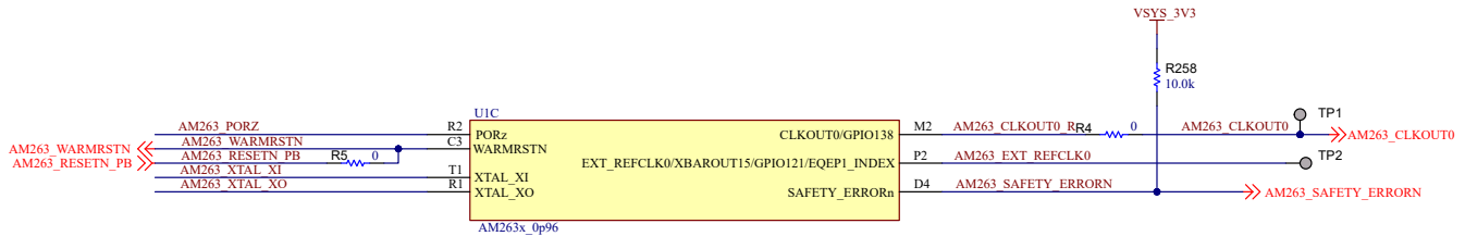
图 3-3. AM263x LaunchPad 布局摘录 - CLKOUT0 和 EXT_REFCLK0 输出
