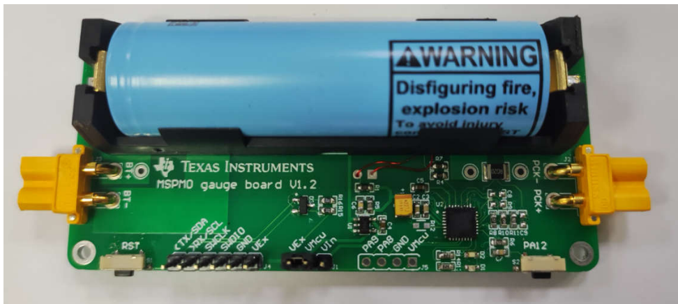
图 1-1. MSPM0 测量仪表硬件板
