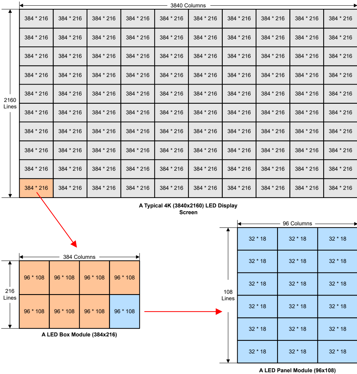
图 1-1. 典型的 4K LED 显示和细分图
