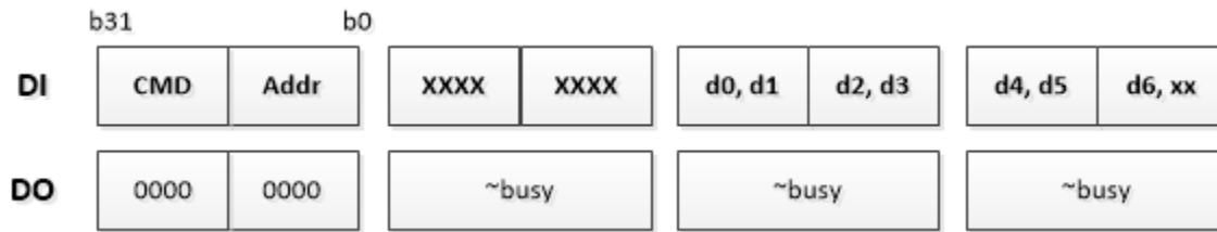
图 3-2. 32 位，大端字节序，写入方向
