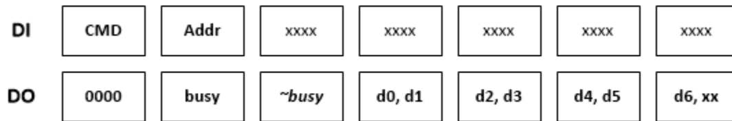
图 3-3. 16 位，大端字节序，读取方向
