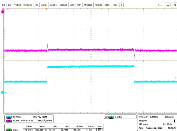
图 4-5. 在 -12Vout 时具有 2.5A 至 5A 负载阶跃的负载瞬态
