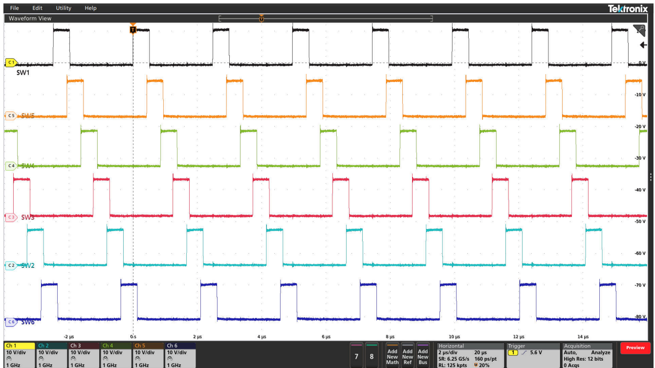
图 5-7. SW 节点电压， V_{IN} = 12V ， V_{OUT} = 3.3V ， I_{OUT} = 2A ，FPWM 模式
